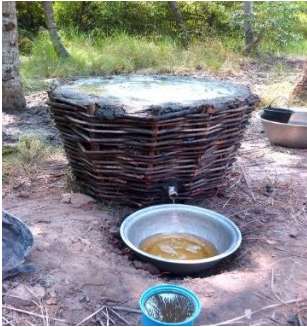
Photo 1 : panier de lixiviation en bois de palétuviers rouges à Heyi-gbadji
