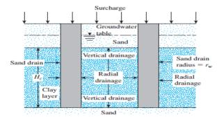
Fig. 2. Sand drains (after, Das 1983)
